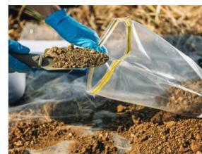
**Figura 3 :** Simulação da coleta de amostras do solo em uma área com caminhamento em ziguezague, ferramenta para retirar as amostras, homogeneização da mistura e retirada de 300 g pra ser enviado a laboratório.
