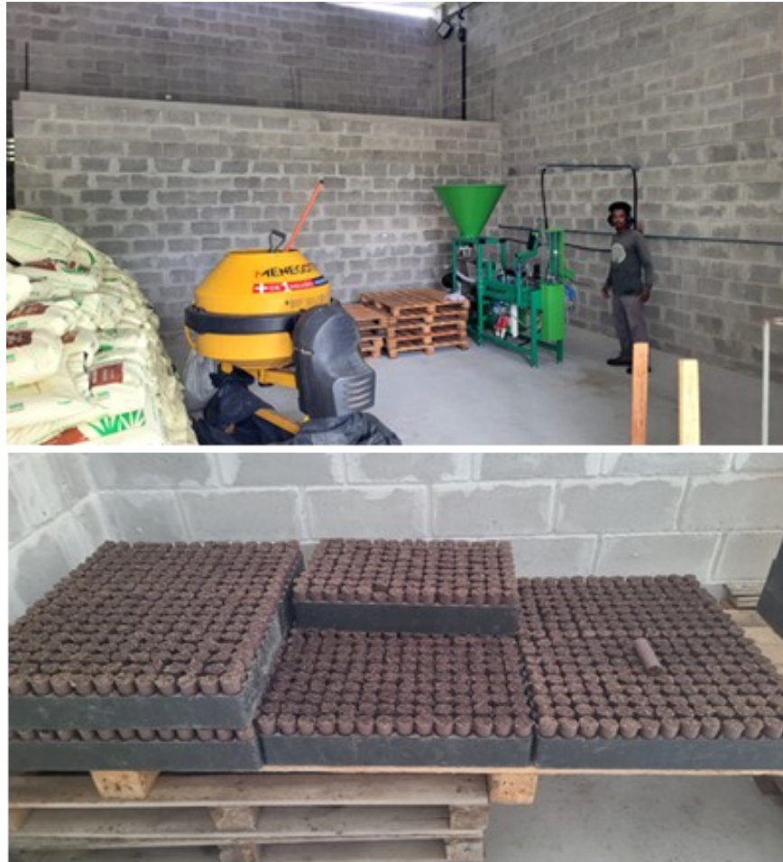
Figura 25. Máquina de Ellepot e primeiros pappers produzidos.
