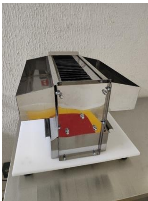
Figura 26. homogeneizador de amostras e mesa para separação de amostras
